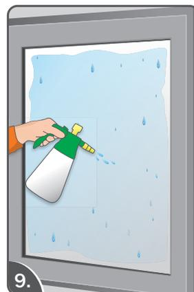
Nochmals die Folie mit Montagewasser besprühen. Danach rakeln Sie die Folie wieder mit Druck von der Mitte nach außen, solange bis das Wasser maximal herausgerakelt wurde.
