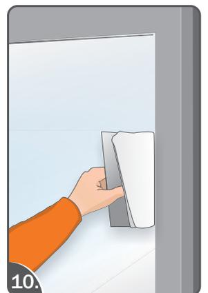
Umwickeln Sie nun noch die Rakel mit einem fussefreien Küchentuch und rakeln nochmal mit mäßigem Druck von der Mitte nach außen, sodass das restliche Wasser vom Küchentuch aufgenommen wird (Küchentuch öfter wechseln).
