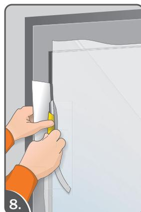
**Achtung: Dieser Arbeitsschritt entfällt beim Maßzuschnitt.** Schneiden Sie die Folie mit der Rakel am Glasrand umlaufend zu. Hierbei sollten Messer und Rakel gleichmäßig zusammen am Rahmen bzw. der Fensterdichtung geführt werden.
