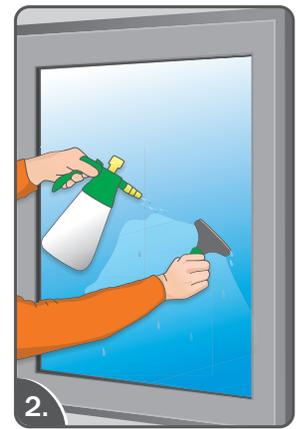
Sprühen Sie die Scheibe unmittelbar vor der Montage mit dem Montagewasser ein und reinigen Sie diese gründlich mit einem Glasschaber. Anschließend trocknen Sie die Scheibe und den Rahmen mit einem Küchentuch.
