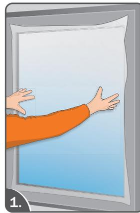
**Achtung: Dieser Arbeitsschritt entfällt beim Maßzuschnitt.** Schneiden Sie die Folie vor der Montage grob vor. Diese sollte umlaufend einge Zentimeter größer sein, als das Glasmaß.
