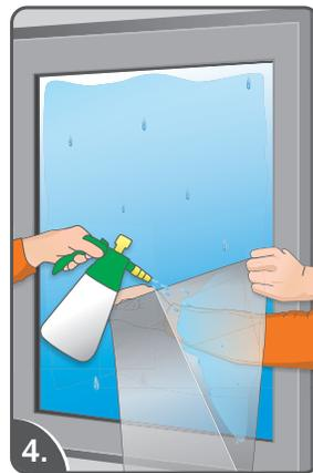
Während eine Person die Folie an zwei Ecken festhält, löst die zweite Person den Schutzfilm komplett ab und sprüht die Klebseite der Folie ein. Danach sprühen Sie die Glasfläche ein.
