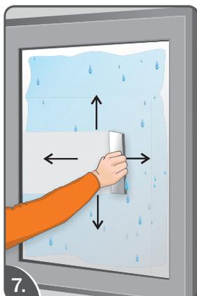
Glätten Sie nun die Folie von der Mitte nach außen, mittels einer Rakel. Hierbei ist ein gewisser Druck nötig, damit möglichst viel Wasser herausgerakelt wird.
